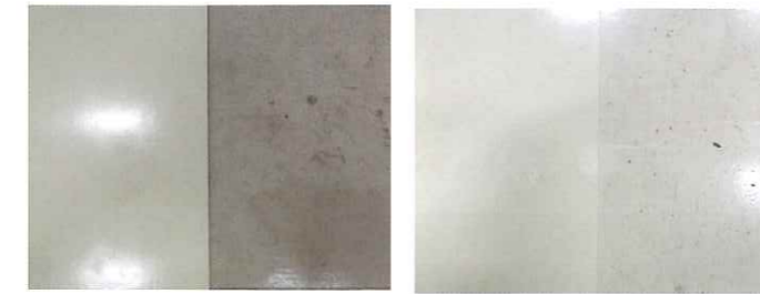
水性アクリル (左:耐汚染試験前 右:試験後2ヶ月) フロアトップアクアW#5000 (左:耐汚染試験前 右:試験後2ヶ月)
