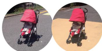
▶同時に計測したベビーカー内の温度も最大 4.6°Cもの温度差!(未塗装路面上 45.3°C、遮熱アイボリー塗装面上 40.7°C。路面より60cmの高さで計測)。大人より路面に近い幼い子どもを暑さから守ります!!
