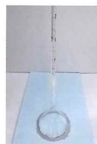
塗膜に水をはった漏斗を設置、24時間後も透水はほとんど認められません。(透水性試験)
