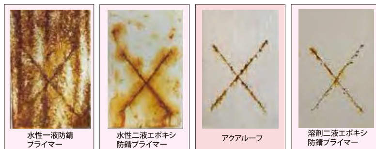
塩水噴霧サイクル腐食試験120サイクル試験結果
